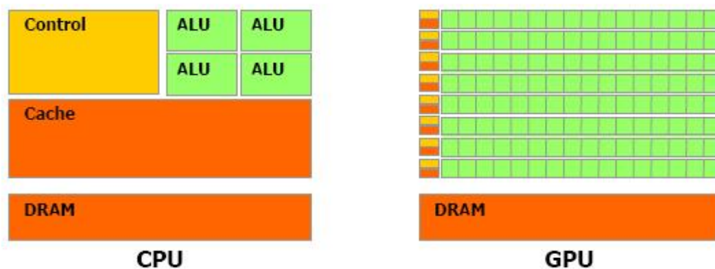
Figure 7: Différence entre architecture CPU et GPU
